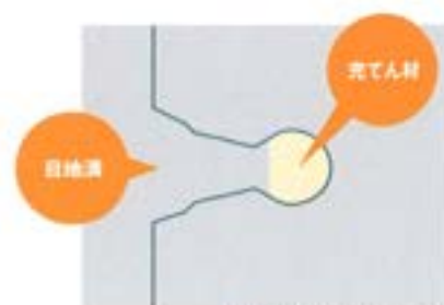
図1 充てん材の充てん状況
