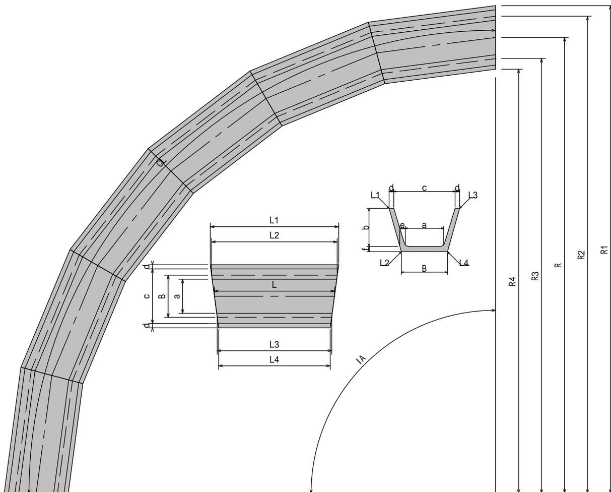
曲線用加工トラフ、トラフのサイズ及びR、IA、CLをご指示頂ければ加工し出荷致します。
